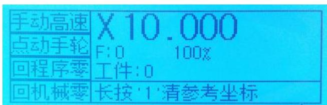
手动高速：手动高低速切换，正显以手动低速运动，反显以手动高速运动。系统参数
